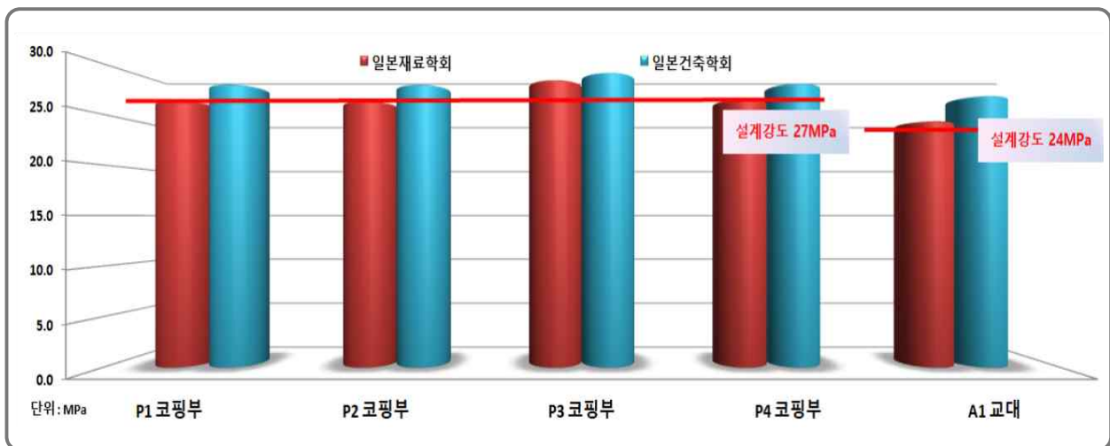
[그림 4.2.3] 반발경도법에 의한 비파괴강도 측정 결과-하부구조
